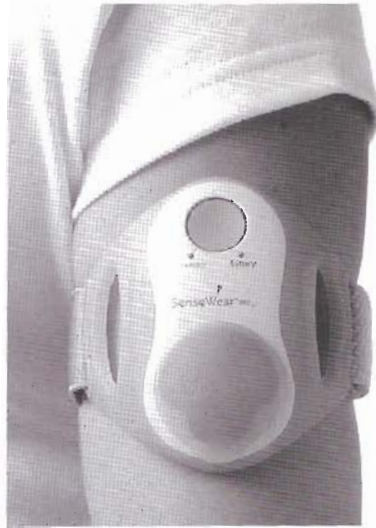
Abb. 1: Multisensorischer Körpermonitor zur Überwachung physiologischer und metabolischer Parameter.
